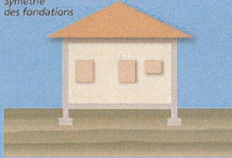
Dissymétrie des fondations
